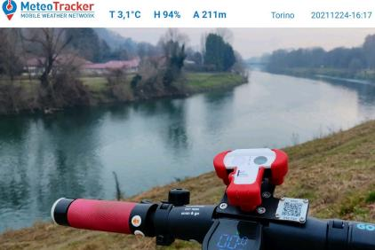
MeteoTracker ist eine mobile Wetterstation, welche sich per Magnet am Fahrzeug oder mit Halterung am Fahrrad (optional) befestigen lässt und hochpräzise Temperatur und Feuchtigkeit misst. Es verbindet sich mit dem Smartphone per Bluetooth und schickt die Messwerte auf eine interaktive Karte über die MeteoTracker App (kostenlos im iOS und Android Store).
